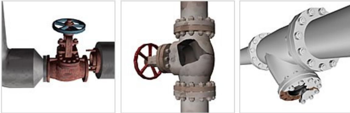
Ejemplo de tubería dañada por el golpe de ariete
